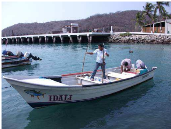
Fig. 1. Embarcación menor (28 pies de eslora) con motor fuera de borda, equipada para la pesca con palangre de deriva.
