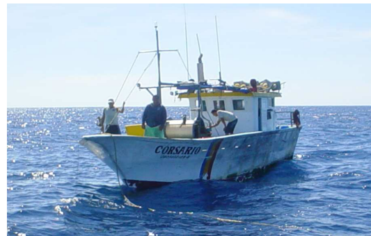
Fig. 2. Embarcación de mediana altura (12 m) con motor de centro, equipada para la pesca con palangre de deriva.
